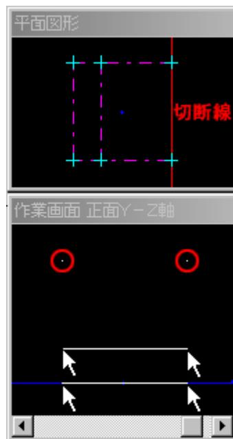
[立方体]メニュー/[面]を選択します。ピッチを[Free]、キャッチを[両端]に設定します。
