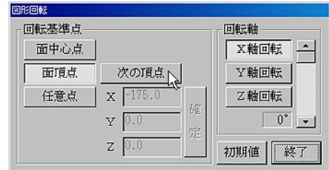
基準点を通るX軸を基準にして回転させますので、[X軸回転]ボタンをクリックし、右側のスクロールバーで「270°」にします。
