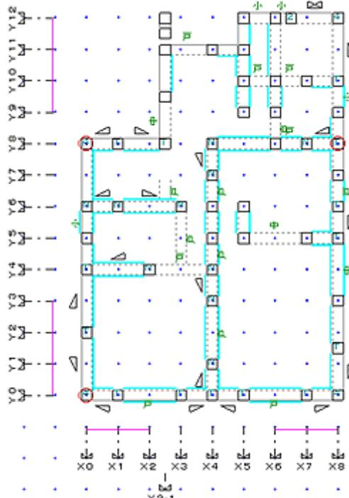
※ 準耐力壁は、両側に耐力壁または準耐力壁があり、面材の横幅が910~2000(mm)であることが条件になります。
